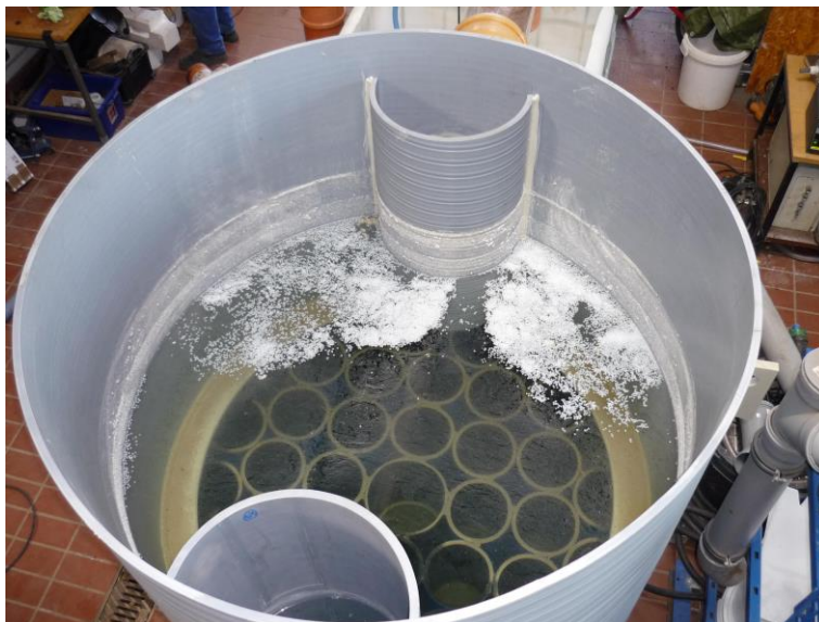
Bild 4 FiltaPex® · modular I pur DN 1400 (ohne Filter), (hier: Testsystem auf dem Prüfstand des PIA, Aachen nach Versuch zum Schwimmstoffrückhalt)
